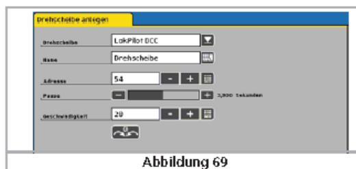
PAUSE: ici il faut insérer une pause, que le décodeur insère entre chaque pas. Chaque longueur de pause doit être plus longue que la vitesse mécanique à savoir que l'amécanique doit pouvoir venir „en repos“.
